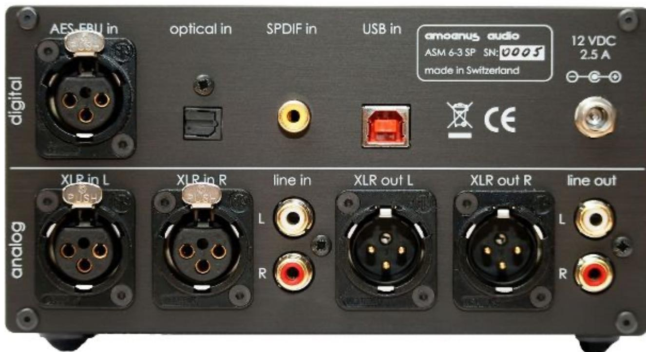
Sur la face arrière, on trouve quatre entrées numériques et deux entrées analogiques. La sortie XLR symétrique est variable, la sortie de ligne possède un niveau fixe.
