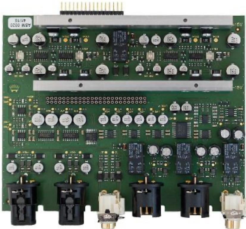
La platine avec le circuit analogique, y compris le contrôle du volume et un étage de sortie ligne en classe A.
